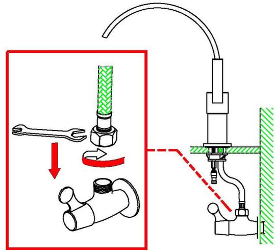
4. Schließen Sie die Wasserschläuche zu Eckventilen samt der Feindichtung an.
