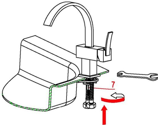
3. Nach Einstellung der Richtung des Hauptkörpers ziehen Sie Sechskantenmutter (7) mit einem Schlüssel an.
